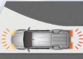
Tự động kích hoạt đèn cảnh báo xe phía sau khi phanh khẩn cấp đảm bảo an toàn cho mọi hành trình.
