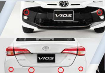
Cảm biến góc trước/sau (mỗi loại 2 cái) và 2 cảm biến sau mang đến sự an tâm khi vận hành. Khách hàng hoàn toàn yên tâm khi vận hành dù trong không gian nhiều chướng ngại vật.
