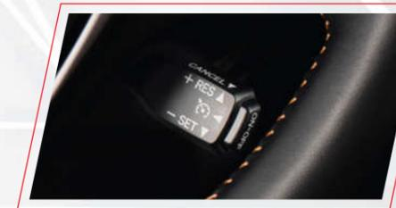
Hỗ trợ kiểm soát tốc độ khi người điều khiển xe không cần tác động vào chân ga, giúp chủ sở hữu thoải mái khi cầm lái đồng thời tiết kiệm nhiên liệu cho xe, hơn nữa còn hỗ trợ điều khiển xe an toàn
