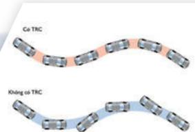
Tự động điều khiển động cơ và hệ thống phanh nhằm tối ưu hóa lực kéo giúp xe dễ dàng khởi hành và tăng tốc trên đường trơn trượt.
